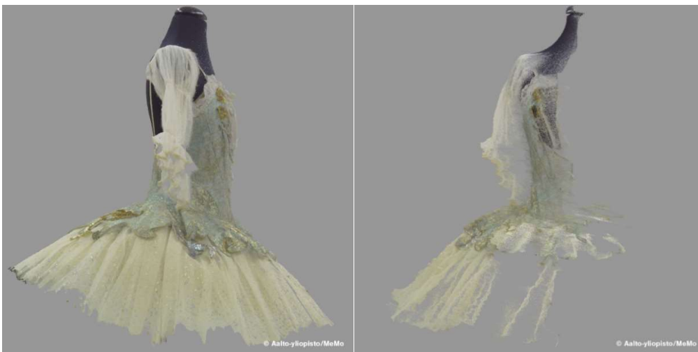
Leica RTC360 -maalaserkeilaimen kokeilu. Kuvassa on värillinen, yksittäinen pistepilvi keilaimen suunnasta ja sama pilvi edestä katsottuna. Pisteet "uppoutuvat" kankaan läpi. Kuvat: Aalto-yliopisto/MeMo.
